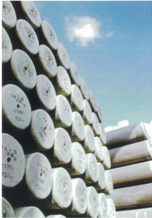
長年にわたるPCパイプ製造の技術と実績を活かしたマエタPCポールをご紹介します。マエタPCポールは、PC鋼棒を使用しプレストレスを与えることにより曲げモーメントに対して大きな抵抗力を持たせてあります。徹底した品質管理の工場で作られる高強度コンクリートを使用したPCポールはひび割れが生じにくくなっています。マエタPCポールは電柱用としてはもちろん、製品の強度と品質の安定性をいかし、各種支柱用として幅広い用途にご利用いただけます。
