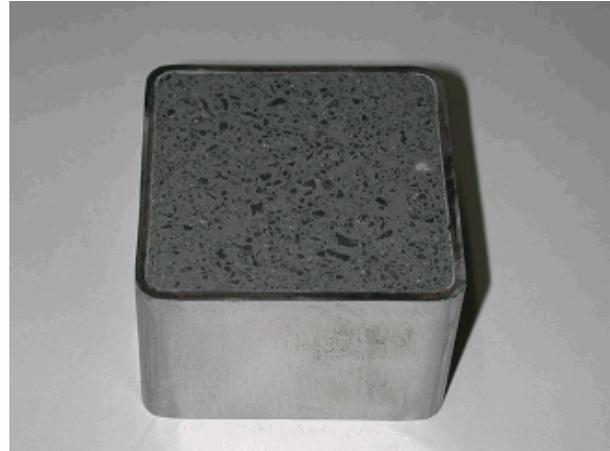
(NFセラミックス充填断面)
