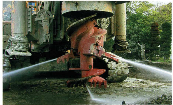
逆転拡大翼 拡翼高圧ジェット噴射時
