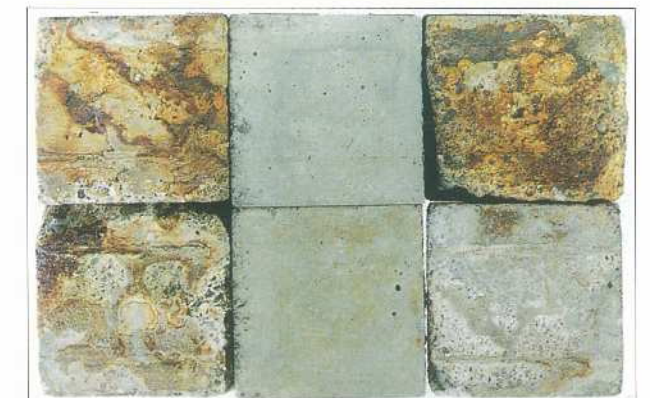
●曝気槽にて2年間暴露試験を行ったテストピースの腐食状況比較
