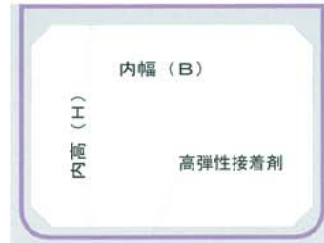
注入区間 (両側壁+底版)
