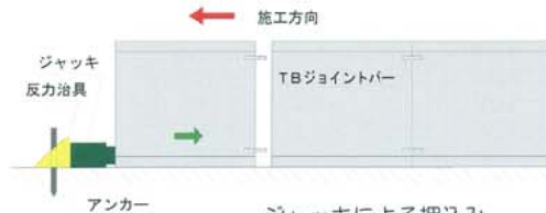
ジャッキによる押込み (コーキング工法は不要)
