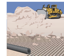
敷網工法 テンサー®SSグレードを主に使用します。広幅・長尺のロール巻です。敷設も容易です。なお、テンサー®同士の接続はホックリングジョイント方式とロープジョイント方式があります。
