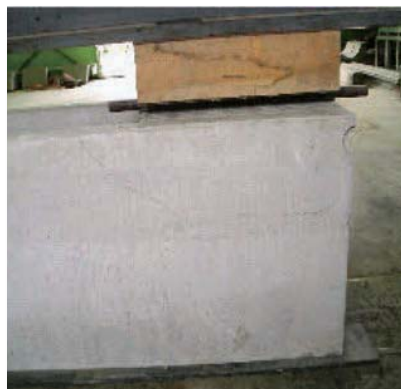
線荷重による梁の載荷試験
