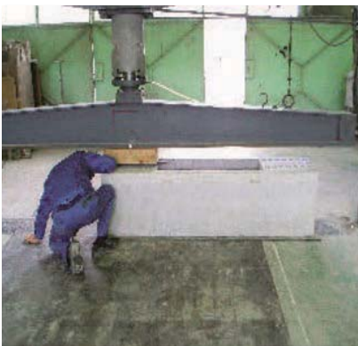
線荷重による梁の載荷試験
