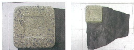
《施工後24年経過シートでの強度試験》
