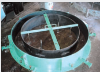
(2) 鋼板リングを型枠にセット
