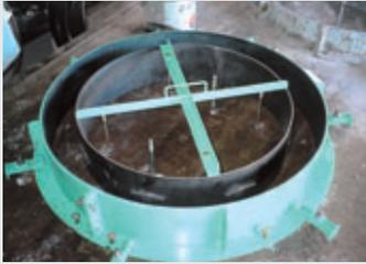
(2)鋼板リングを型枠にセット
