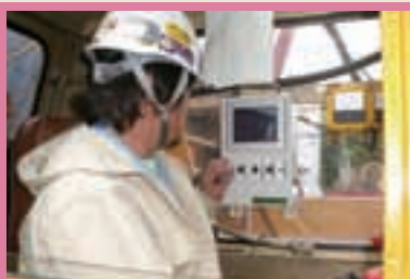
操作盤 (運転席に設置)
